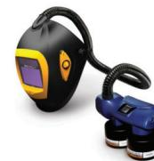
Avtomatska zaščitna čelada za varilce, osnovana na uporabi optičnega LCD-preklopnika: Prepuščena svetloba se avtomatsko prilagaja tako, da varilec lahko nemoteno in varno dela. V zahtevnejših delovnih pogojih (plini, dim,) omogoča tudi uporabo sistema, ki dovaja »čist zrak« neposredno v čelado.
