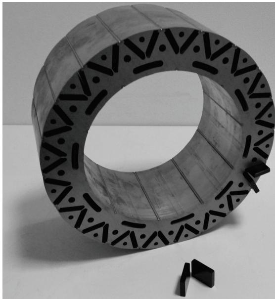
Nd-Fe-B magneti, izdelani po inovativni tehnologiji in vgrajeni v motor za električno vozilo v francoski firmi Valeo. Test je pokazal 13-odstotno izboljšanje delovanja motorja v primerjavi z referenčnim motorjem; vrtlni navor se je povečal za 11 % pri  $\Delta T$  95 K. Oba parametra prispevata k boljši učinkovitosti.
