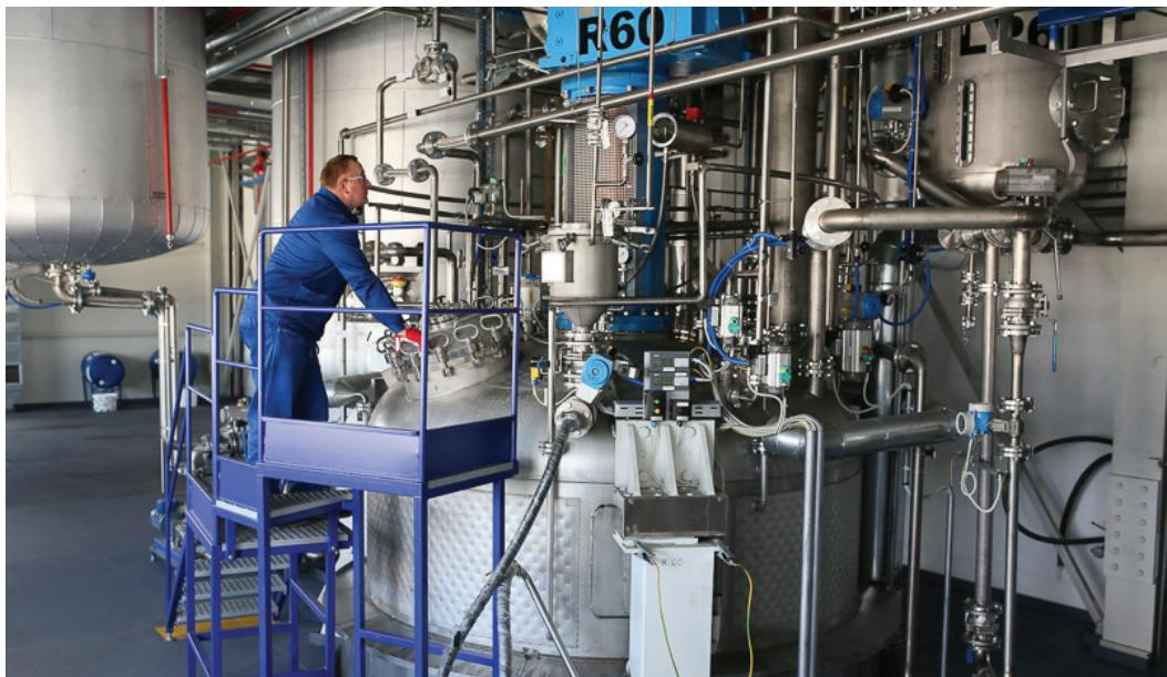
Izziv za dr. Venturinija je stalno posodabljanje produktov in uvajanje novih tehnologij. Za proizvodnjo okolju prijaznih premazov je podjetje Helios TBLUS postavilo novo reaktorsko linijo za sintezo polimerov na vodni osnovi.
